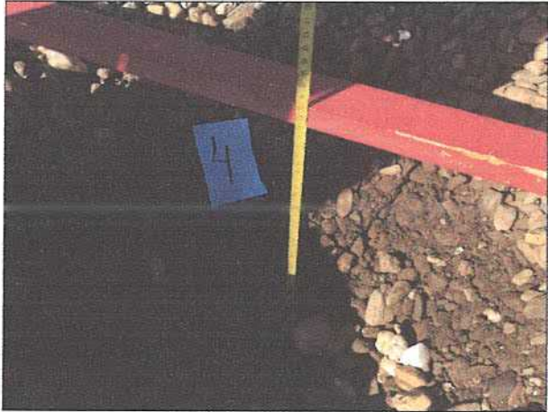
Мерење дебљине слоја и изглед гранулације шљунка
