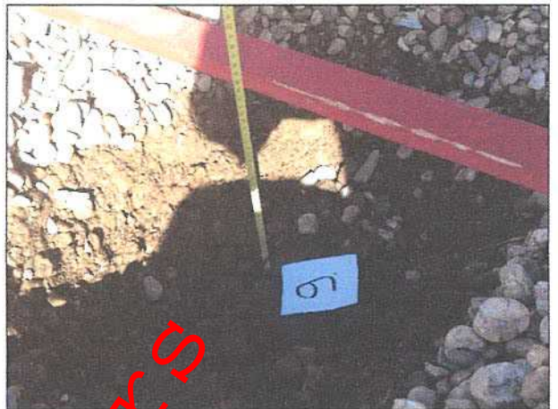
Мерење дебљине слоја и изглед гранулације шљунка
